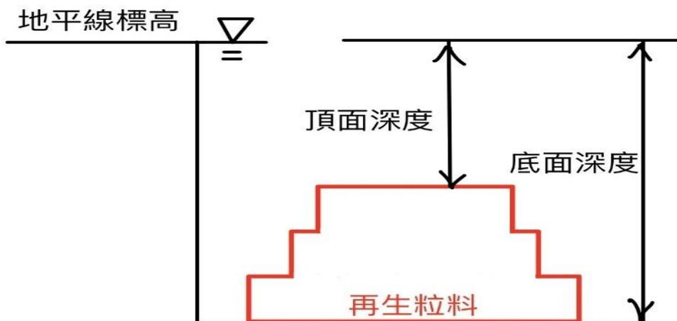
圖 3.13 頂/底面深度示意圖
