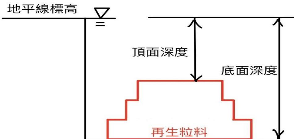
圖 3.13 頂/底面深度示意圖
